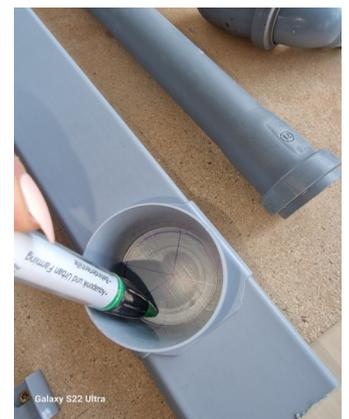
Um den Wasser-Ablauf zu bauen, brauchen wir als nächstes die 1,30 m lange Dachrinne, den Ablauf, einen Stift und die 40 mm Bohrkronen. Zuerst wird der Ablauf auf die gewünschte Position der Rinne geschoben. Diese Stelle markieren wir mit dem Stift, dann wird der Ablauf wieder entfernt.
